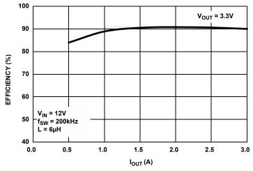
FIGURE 1. ZL2103 EFFICIENCY
