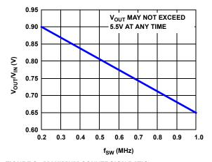
FIGURE 8. MAXIMUM CONVERSION RATIO,  $\label{eq:T_J} \textbf{T}_J \leq \textbf{+125}\,^{\circ}\textbf{C}$
