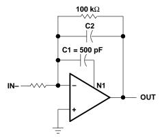
**Figure 3. Feed-Forward Compensation**
