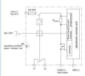
Wiring diagram ESS31-TC-001-... (Example)
