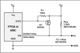
Figure 1. The DS1WM typical application circuit.
