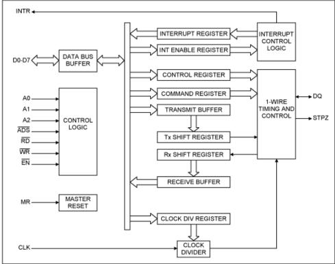
Figure 2. The DS1WM block diagram.
