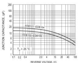
FIG.6 TYPICAL JUNCTION CAPACITANCE
