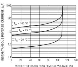
FIG.3 TYPICAL REVERSE CHARACTERISTICS
