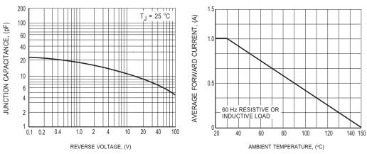
FIG.2 TYPICAL JUNCTION CAPACITANCE
