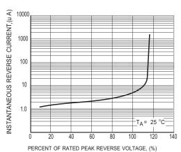
FIG.2 MAXIMUM REVERSE CHARACTERISTICS
