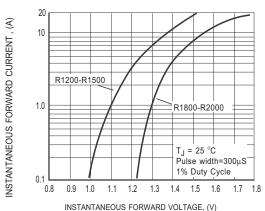
FIG.3 MAXIMUM INSTANTANEOUS FORWARD CHARACTERISTICS
