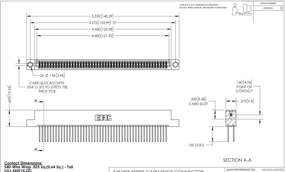
LG=.560(14.22) .100 (2.54) Contact Spacing x .200 (5.08) Row Spacing
