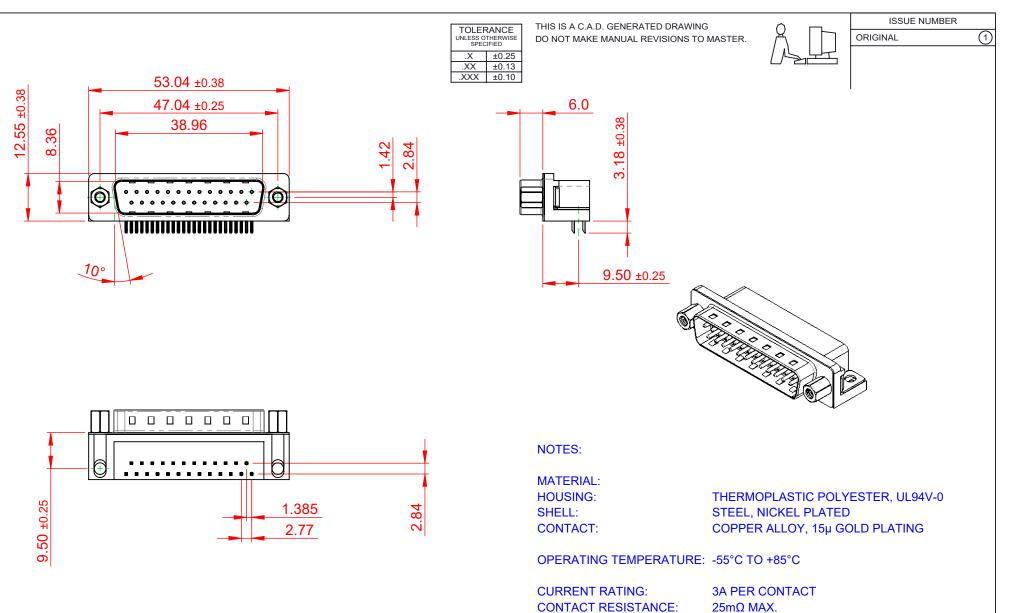
**INSULATOR RESISTANCE:** 5000MΩ min.
