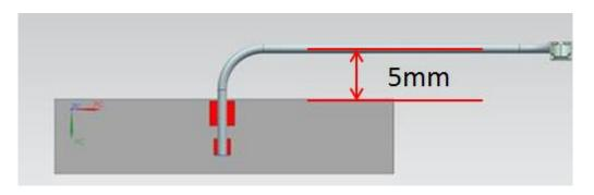
**FIGURE 7.2 CABLE BENDING**
