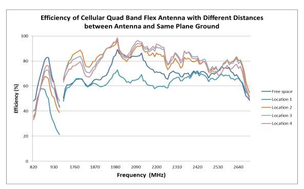
FIGURE 4.3.2 EFFICIENCY OF ANTENNA AT FOUR LOCATIONS WITH SAME PLANE GROUND
