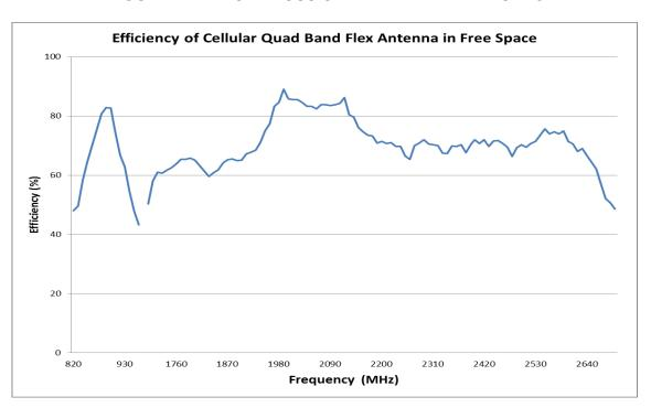
FIGURE 2.3 EFFICIENCY OF ANTENNA IN FREE SPACE
