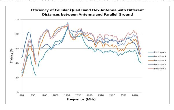
FIGURE 4.2.2 EFFICIENCY OF ANTENNA AT FOUR LOCATIONS WITH PARALLEL GROUND
