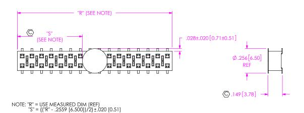
FIG 4 -K: POLYMIDE FILM PAD **AVAILABLE ON POS 03 THRU 50**
