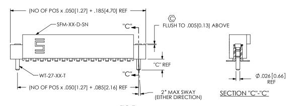
FIG 7 -SNX: SOLDER NAIL (SAME AS FIG 1, DIFFERENT AS SHOWN)
