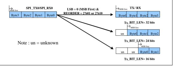
Figure 6-93 SPI Byte Reorder
