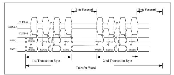
Figure 6-94 SPI Byte Suspend Mode
