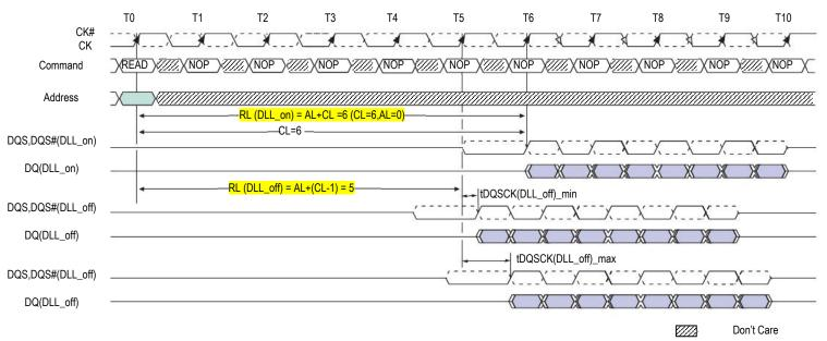
Note: The tDQSCK is used here for DQS, DQS, and DQ to have a simplified diagram; the DLL\_off shift will affect both timings in the same way and the skew between all DQ, DQS, and DQS# signals will still be tDQSQ.
