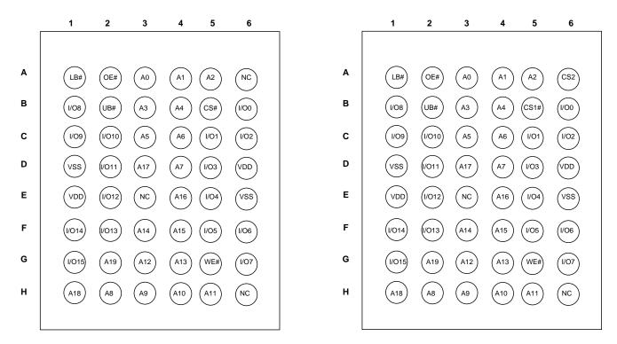
48-Pin mini BGA, 1 Chip Select, A19 on H6 (B3), 48-Pin mini BGA, 2 Chip Select, A19 on H6 (B4)
