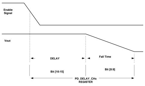
Fig. 25: Channel Soft-Stop Sequence
