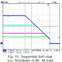
CH1: 3.3V, CH2: 5V, CH3: 1V, CH4: 1.8V
