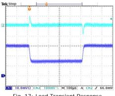
Fig. 17: Load Transient Response CH1: Iout (1A/div) CH2:Vout(3.3V)
