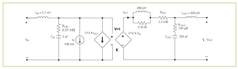
**Figure 13** — V•I Chip<sup>™</sup> module AC model
