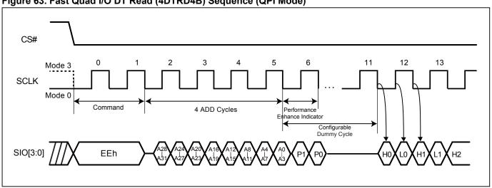
Figure 63. Fast Quad I/O DT Read (4DTRD4B) Sequence (QPI Mode)
