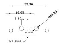
RECOMMENDED PCB LAYOUT \*TYPICAL // HOLE SIZE MAY NOT BE SUITABLE FOR YOUR SPECIFIC APPLICATION
