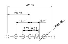
RECOMMENDED PCB LAYOUT \*TYPICAL // HOLE SIZE MAY NOT BE SUITABLE FOR YOUR SPECIFIC APPLICATION
