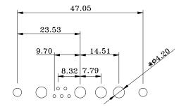
RECOMMENDED PCB LAYOUT \*TYPICAL // HOLE SIZE MAY NOT BE SUITABLE FOR YOUR SPECIFIC APPLICATION
