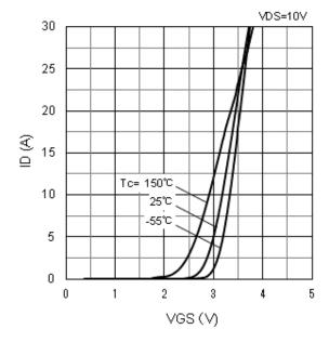
Figure 7. I<sub>D</sub> vs. V<sub>GS</sub>
