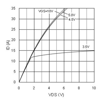
Figure 6. I<sub>D</sub> vs. V<sub>DS</sub>
