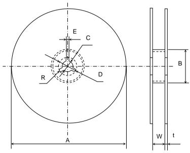
(Unit: mm) Symbol Α В С D Е W  $\phi$  382 max. Dimension  $\phi$  50 min.  $\phi$  13±0.5  $\phi$  21±0.8  $2.0\pm0.5$ 10.0±1.5 (Nominal  $\phi$  330)
