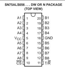
(TOP VIEW) 20 🛮 B1 D1 Γ 19 E1 R1 🛮 2 D2 [] 3 18 B2 R2 [] 4 17 ∏ E2 16 GND V<sub>CC</sub> 🛭 5 D3 [ 6 15 B3 14**∏** E3 R3 **∏** 7 13 🛮 B4
