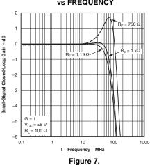
**SMALL-SIGNAL CLOSED-LOOP GAIN** vs FREQUENCY
