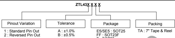
E5/SE5 : SOT25 FF : SOT23F F : SOT23 H6 : SOT363 in SOT23/SOT23F
