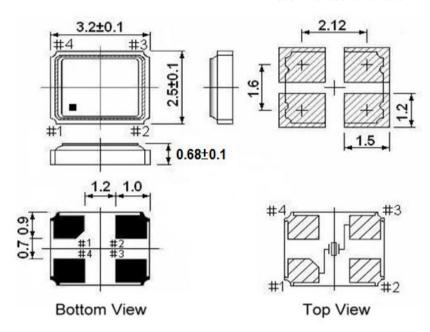
\*\* Recommended - Pin 1 & 3 : CRYSTAL Pin 2 & 4 : GND
