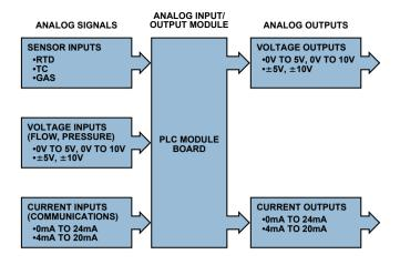
Figure 3. Analog input/output module.
