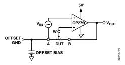
Figure 27. Noninverting Gain
