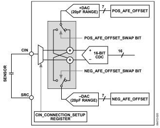
Figure 22. Analog Front-End Offset Control
