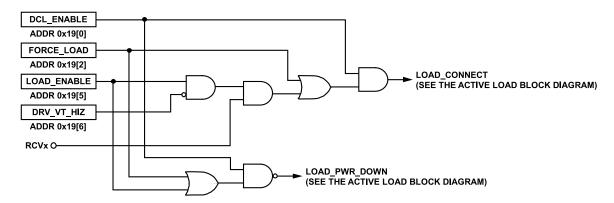
$$\begin{split} & \mathsf{LOAD\_CONNECT} = \mathsf{DCL\_ENABLE} \times (\mathsf{FORCe\_LOAD} + \mathsf{RCVx} \times \overline{\mathsf{DRV\_VT\_HIZ}} \times \mathsf{LOAD\_ENABLE}) \\ & \mathsf{LOAD\_PWR\_DOWN} = \overline{\mathsf{DCL\_ENABLE}} + \overline{\mathsf{FORCe\_LOAD}} \times \overline{\mathsf{LOAD\_ENABLE}} \end{split}$$
