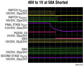
48V TO 1V AT 50A SHORTED LAST STAGE 1V OUTPUT  $V_{OUTC0}$  AND  $V_{OUTC1}$  IN PARALLEL
