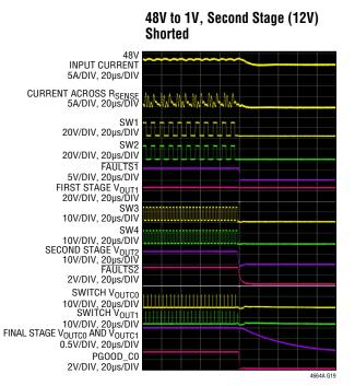
48V TO 1V AT 50A V<sub>OUT2</sub> STAGE 12V OUTPUT SHORTED
