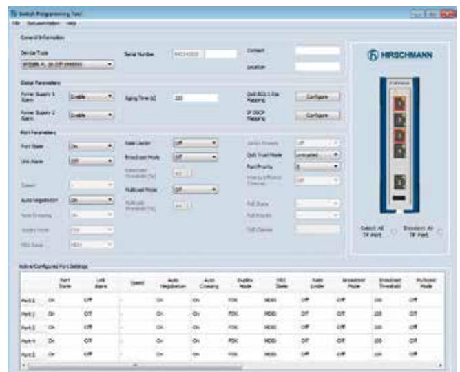
Das eigenständige Programmier-Tool der Switches, über das sich jeder Port individuell an die Anforderung der jeweiligen Anwendung anpassen lässt, läuft ohne Installation (auch von einem USB-Stick).
