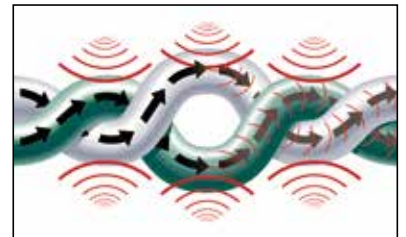
Abbildung 1: Beispiel für nicht verschweißte Adernpaare. Wenn das Kabel gedehnt und gezogen wird, beginnen die Paare sich zu trennen, wodurch die Signalqualität verringert wird.
