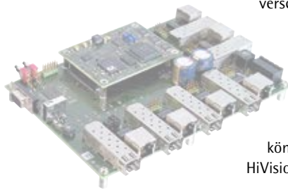
Embedded Ethernet Switch EES25 auf Entwicklungskit
